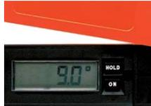
Der Winkel wird auf dem LCD-Display direkt abgelesen. Messbereich 355°. Anzeige in 0,1°-Schritten
