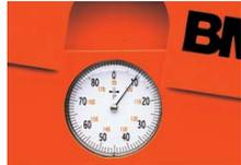
Der Winkel wird auf der Winkel-messuhr direkt abgelesen. Doppelte Skala von 0–90° und 90–180°
