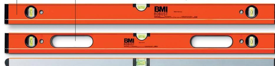
Die Profi-Wasserwaage für höchste Ansprüche, bis 120 cm zwei gefräste Messflächen für beidseitiges, zuverlässiges Messen in jeder Lage. 2 Vertikal- und 1 Horizontallibelle. Oberfläche pulverbeschichtet. Extrem verwindungssteif durch 4-Kammer-Profil. Horizontal-
